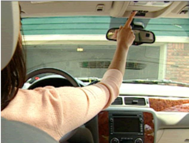
Para programar otro dispositivo con código variable, como un abridor de portón de garaje adicional, un dispositivo de seguridad o las luces de la casa, repita los pasos del 1 al 4 sustituyendo por otro en el Paso 3, el botón que eligió antes para abrir el portón del garaje. Por ejemplo, puede asignar el botón de la izquierda para el portón del garaje, el botón del centro para un dispositivo de seguridad y el de la derecha para el abridor de otro portón de garaje.
