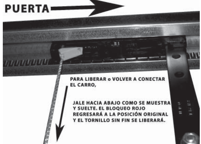
FIG. 6-3 Liberación del carro
