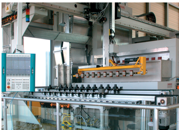
Abb.5: Portalroboter und Handhabungstechnik
