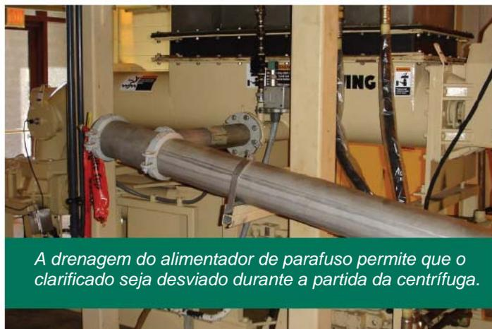
A drenagem do alimentador de parafuso permite que o clarificado seja desviado durante a partida da centrífuga.
