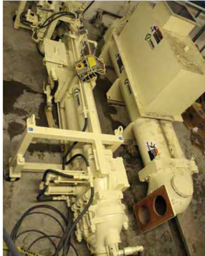
Bomba de êmbolo Schwing Bioset modelo KSP 45 V(HD)L e parafuso alimentador SD 350 que bombeia até a estação de carga de caminhões. (Mostrado durante a instalação)
