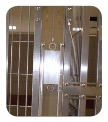
TRANSFER DOORS UTILIZE A SIMPLE COUNTER-BALANCE PULLEY SYSTEM
