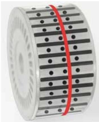
Esto se aplica a las máquinas que utilizan una rueda de vacío de tipo tambor en el alimentador (de alimentación continua o amontada) como se muestra aquí, que es común en la mayoría de plegadoras populares.
