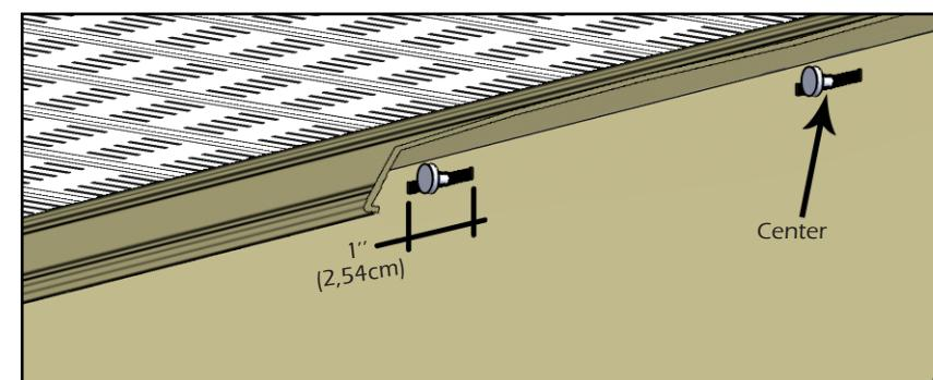
Si vous devez fixer les panneaux dans un endroit autre que dans les trous de fixation, faire une fente de 1"(2,54 cm) pour permettre de clourer. Toujours clourer au centre de la fente.
