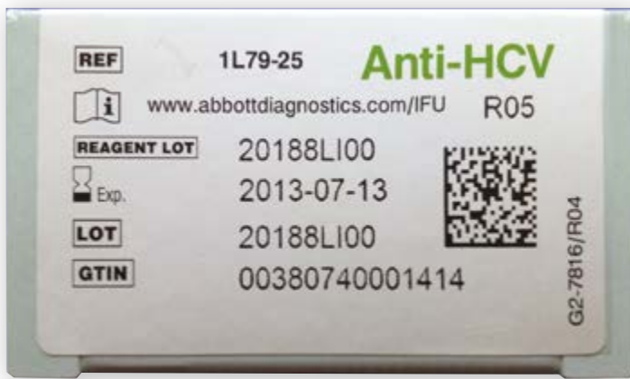
Una prueba diagnóstica para el virus de la Hepatitis C (anti HCV) utiliza un código de barras DataMatrix GS1 y un GTIN de 14 dígitos. La fecha de vencimiento utiliza el formato ISO 8601 (YYYY-MM-DD).
