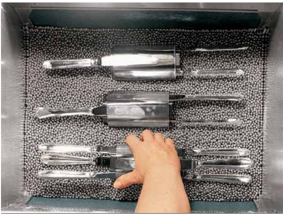
Messerklingschutz Verhindert das Stumpfwerden der Klingen und poliert gefahrlos die Griffe. * Benutzen Sie zum Polieren der Messer immer den Klingenschutz, da ansonsten das Förderband beschädigt werden könnte.
