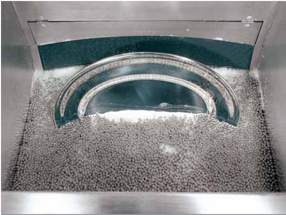
Polieren von Platten, Schüsseln, Abdeckhauben, Eiskübel etc. Polishing of platters, dishes, lids, ice buckets etc.
