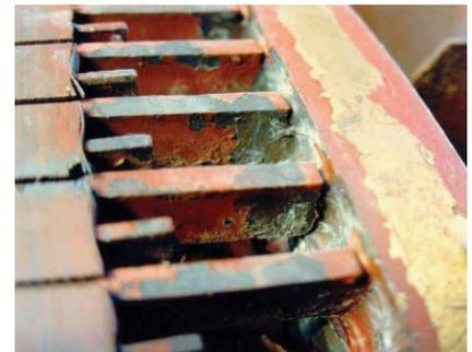
Broken rotor bar
