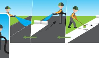
Retire ReliableCure SOG® después del período de curado especificado, enrolle la manta en secciones manejables y deséchela junto con otros desechos de construcción. No se recomienda dejar la manta después del período especificado, ya que puede ser necesario aplicar agua adicional debajo de la manta para ayudar en la eliminación.
