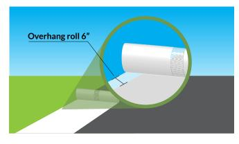
Mientras continúa hidratando la manta en el borde delantero con la manguera de alto volumen, comience a extenderla lentamente, con la tela hacia abajo. La manta cambiará de blanco a gris cuando esté completamente hidratada. Si la manta se extiende demasiado rápido y el color blanco aun está presente, simplemente enrolle la manta unos pocos pies y aplique agua adicional antes de continuar.
