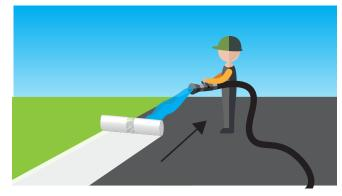
Si se notan bolsas de aire durante la instalación, use una escoba de cerdas suaves para empujar el aire por el lado de la manta hacia el lado descubierto de la losa.
