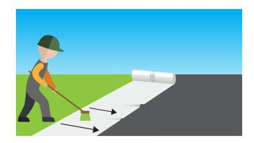
6 Continúe con los pasos 4-5, sobreponiendo la manta de cuatro a seis pulgadas en cada sección, hasta cubrir toda la losa.
