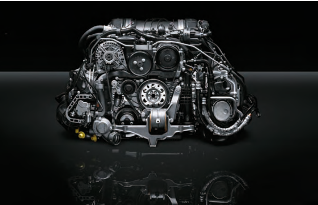
Motor boxer de 6 cilindros y 3,4 litros del Cayman S
