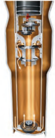
Fase de estiramiento – émbolo de trabajo sólo, ajuste deportivamente duro
