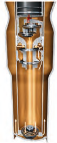
Fase de compresión – émbolo de trabajo sólo, ajuste deportivamente duro
