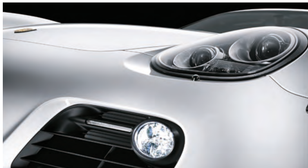
Faros Bi-Xenón con luz de curva dinámica y luces de conducción diurna de LED3
