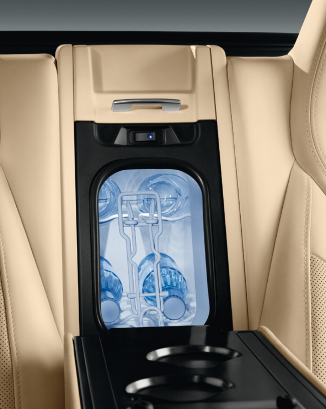
Compartimento refrigerado de la parte trasera
