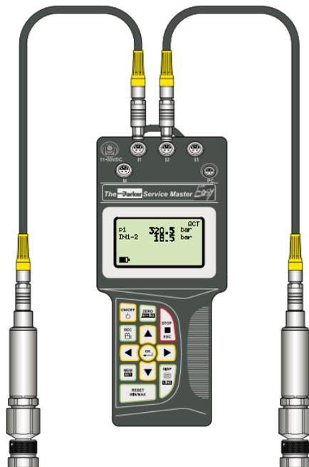
Aparato de medición con dos sensores de presión
