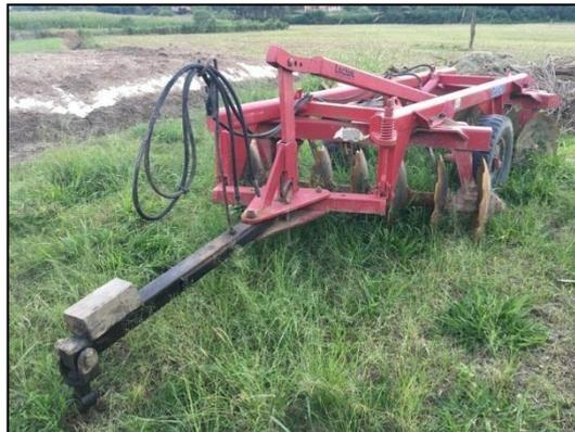
Figura 7: Grade Aradora utilizada na operação.
