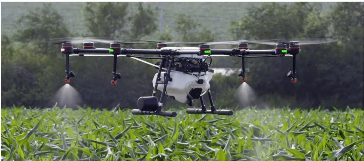
Figura 8: Drone Pulverizador.
