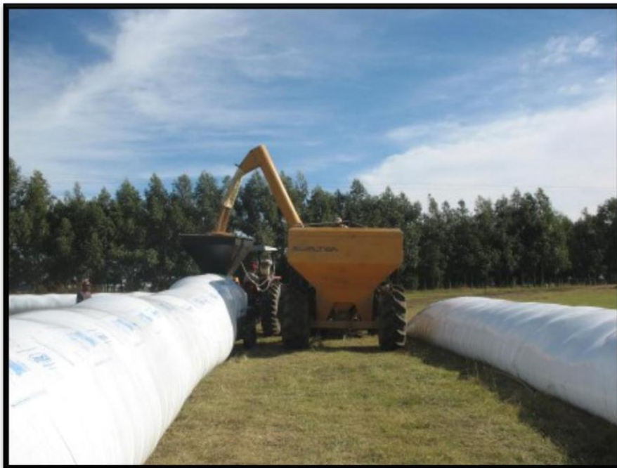
Figura 7: Moinho e compactador de silo Bag's . Fonte: THOMPSON, 2012.
