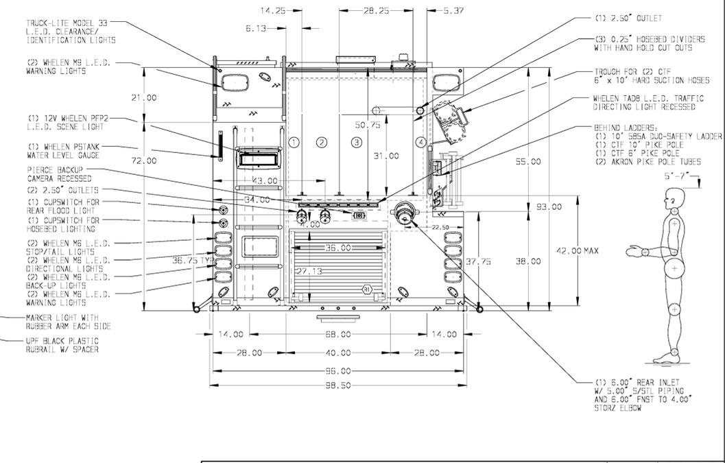
ALUMINUM BODY    MAXIMUM O.A.H. - 126.00"    MAXIMUM O.A.L. - 380.00"    SIDE ROLL PROTECTION    FRONTAL IMPACT PROTECTION
