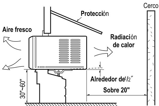
Atención: Todas las partes de la persiana de la cabina deben quedar expuestas y sin obstrucciones por la parte exterior de la estructura.
