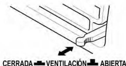
NOTA : Antes de usar la función de ventilación, coloque la palanca de ventilación tirando hacia fuera de la Parte (A) y presionándola en su lugar (B)
