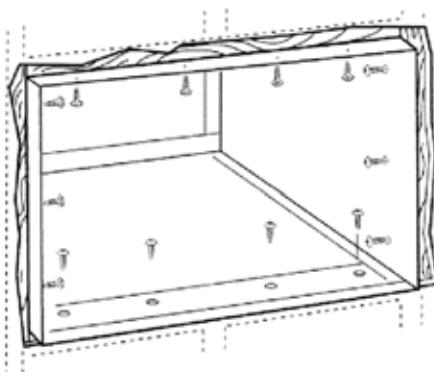
**C** Coloque la caja en la abertura de la pared y coloque las bandas de soporte de madera entre la parte inferior de la caja y los tapajuntas de ambos lados del riel inferior. Deben ser de la misma altura que el riel inferior y de la misma longitud que la abertura de la pared.
