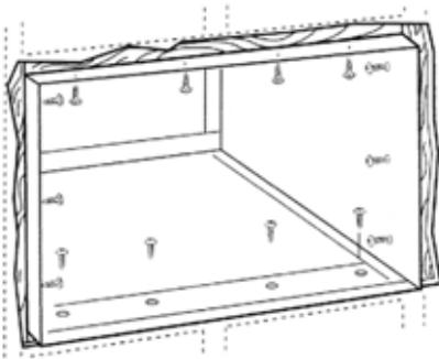
C Placez le cas dans l'ouverture de mur et les bandes en bois de soutien d'endroit entre le fond de cas et le clignotant des deux côtés du fond rail. Ils devraient être la même taille que le rail inférieur et la même longueur que l'ouverture de mur.
