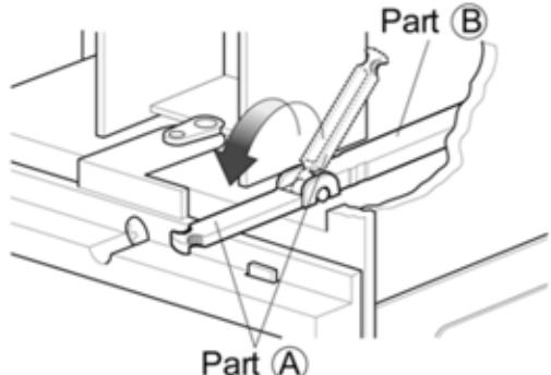
NOTE: La poignée de contrôle du ventilateur doit être redressée avant que la partie décorative frontale soit fixée. Tirer la partie® à aligner avec la partie®.
