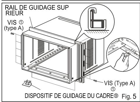
6. Insérez les volets d'étanchéité dans le rail de guidage supérieur et dans les dispositifs de guidage du cadre. (Fig 5)
