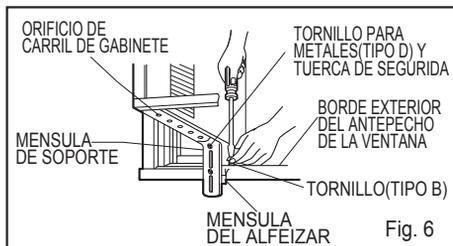
3. Utilizando el tornillo M y la tuerca de seguridad, coloque la ménsula de soporte en el orificio de la guía del gabinete. Use el primer orificio de la guía después de la ménsula del alfiler en el borde exterior del alféizar de la ventana.
