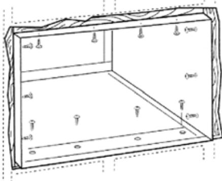
**C** Coloque la caja en la abertura de la pared y coloque las bandas de soporte de madera entre la parte inferior de la caja y los tapajuntas de ambos lados del riel inferior. Deben ser de la misma altura que el riel inferior y de la misma longitud que la abertura de la pared.
