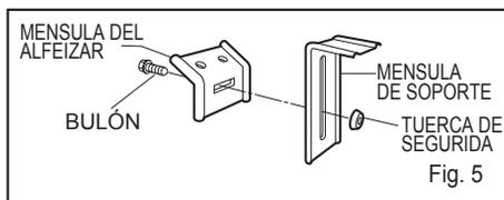
2. Coloque la ménsula del alféizar en el alféizar de la ventana utilizando los tornillos (Tipo B). Apriete el perno y la tuerca de seguridad.
