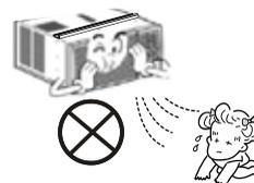
**Pour le nettoyage de l'intérieur, veuillez contacter un Centre de Service Agréé ou un concessionnaire. N'utilisez pas de détergent puissants qui provoquent la corrosion ou endommagent l'unité.**
