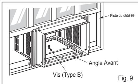
3. Tirez entièrement chaque Rideau du cadre à châssis inférieure de la fenêtre vers le bas derrière le bague d'arrêt Supérieure jusqu'à ce qu'il se rencontre.
