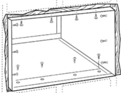
**C** Placez le cas dans l'ouverture de mur et les bandes en bois de soutien d'endroit entre le fond de cas et le clignotant des deux côtés du fond rail. Ils devraient être la même taille que le rail inférieur et la même longueur que l'ouverture de mur.
