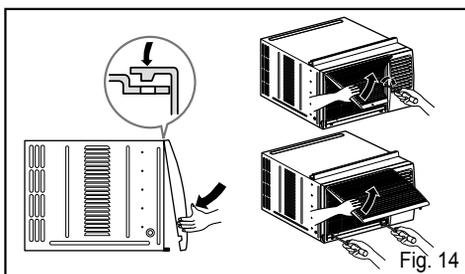
9. Soulevez la grille d'entrée d'air et sécurisez là avec une vis (Type A) passée à travers la grille avant. (See Fig. 14)
