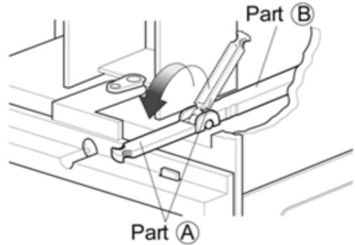
NOTE: La poignée de contrôle du ventilateur doit être redressée avant que la partie décorative frontale soit fixée. Tirer la partie A à aligner avec la partie B.
