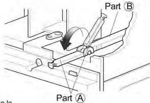
NOTA : Antes de usar la función de ventilación, coloque la palanca de ventilación tirando hacia fuera de la Parte (A) y presionándola en su lugar (B)
