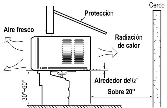
Atención: Todas las partes de la persiana de la cabina deben quedar expuestas y sin obstrucciones por la parte exterior de la estructura.
