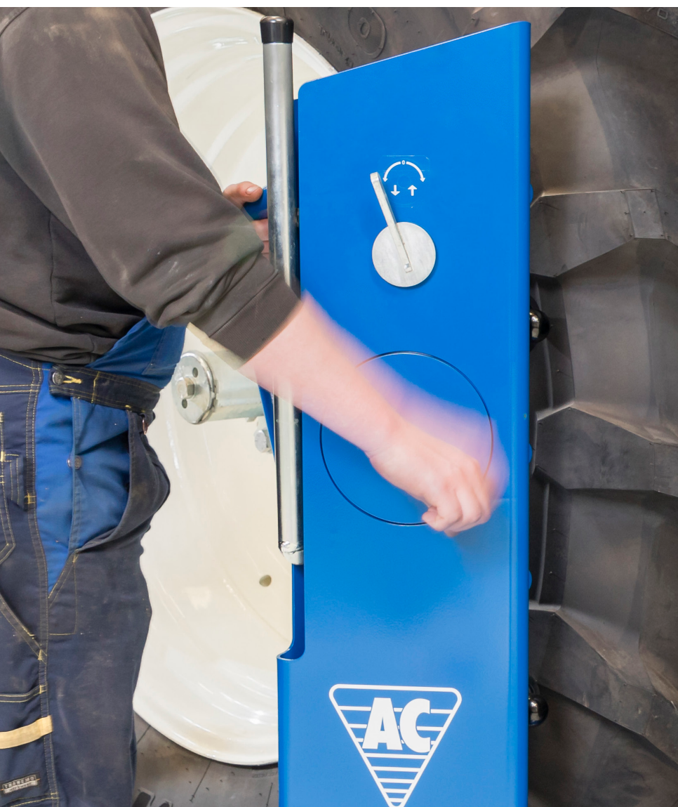
Ved montering roteres hjulet nemt, så hjulbolte og nav passer perfekt
