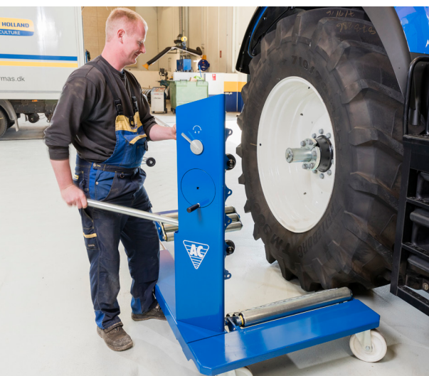
Ved montering roteres hjulet nemt, så hjulbolte og nav passer perfekt
