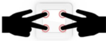
Hat's geklappt und ist der Cello im Konfigurationsmodus, zeigt er Ihnen dies mit 4 violetten Leuchtpunkten auf der Oberfläche an.
