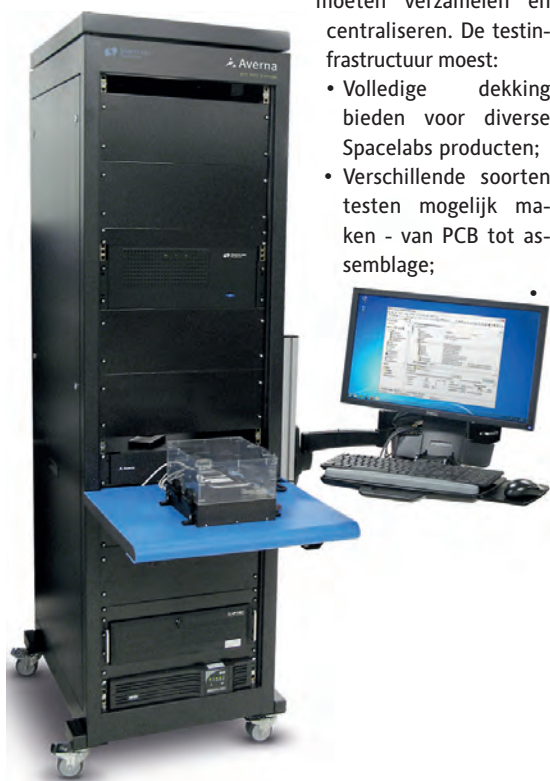
Een van de tien door Averna ontwikkelde teststations met beeldscherm en testfixture.
