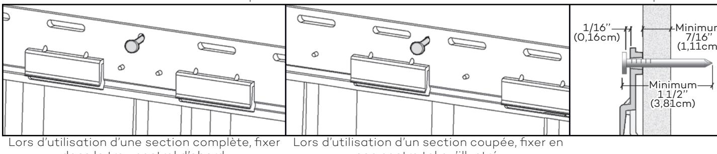
Lors d'utilisation d'une section complète, fixer dans le trou central d'abord.
