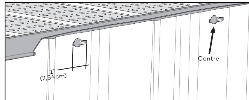
Si vous devez fixer les sections dans un endroit autre que dans les trous de fixation, faire une fente de 1"(2,54 cm) pour permettre de clouer. Toujours clouer au centre de la fente.
