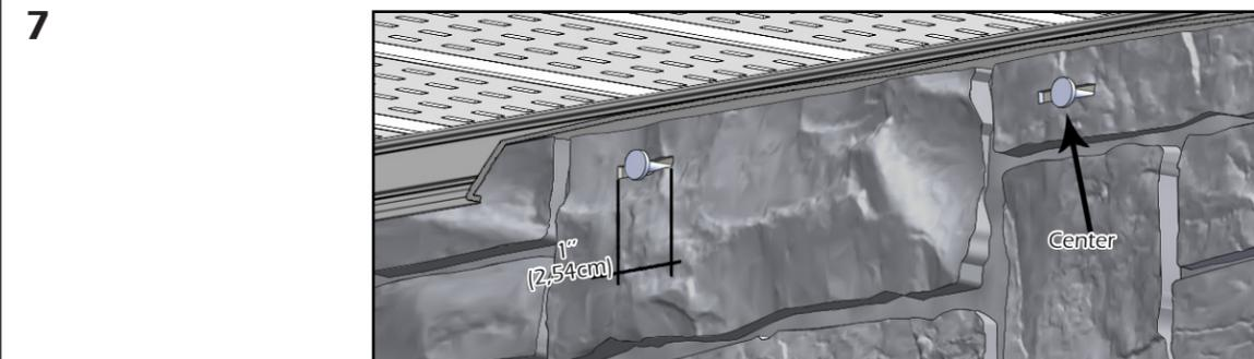
Si vous devez fixer les panneaux dans un endroit autre que dans les trous de fixation, faire une fente de 1"(2,54 cm) pour permettre de clouer. Toujours clouer au centre de la fente.
