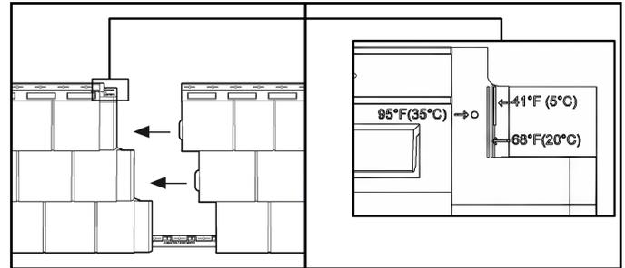
5-Partir le second rang en coupant à 16" (40,64cm) de distance de votre point de coupe de la rangée de départ. Glisser les crochets situés au bas du panneau dans le haut de la rangée précédemment installée. Pour éviter la répétition, alterner la séquence de coupe pour les rangées subséquentes. (Figure E)
