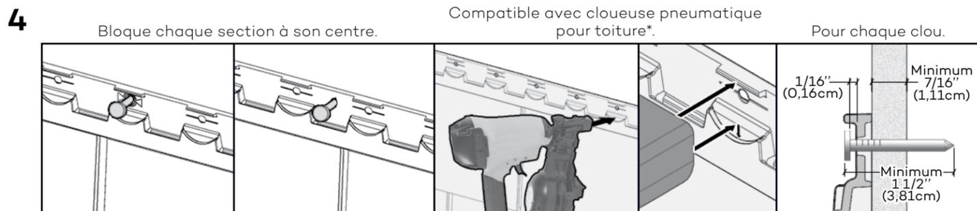
Lors d'utilisation d'une section complète, fixer dans le trou central d'abord. Lors d'utilisation d'un section coupée, fixer en son centre tel qu'illustré. Pour chaque clou, laisser un espace entre la tête du clou et la section. Lors de l'utilisation d'une cloueuse pneumatique, ajuster l'embout à la plus haute position ainsi que la pression d'air selon le substrat afin de laisser l'écart nécessaire.
