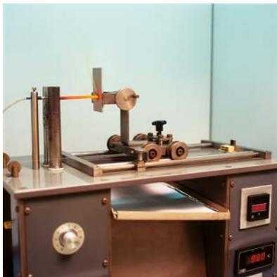
**Ensayo del hilo incandescente s/EN 61537: 960°C.**
