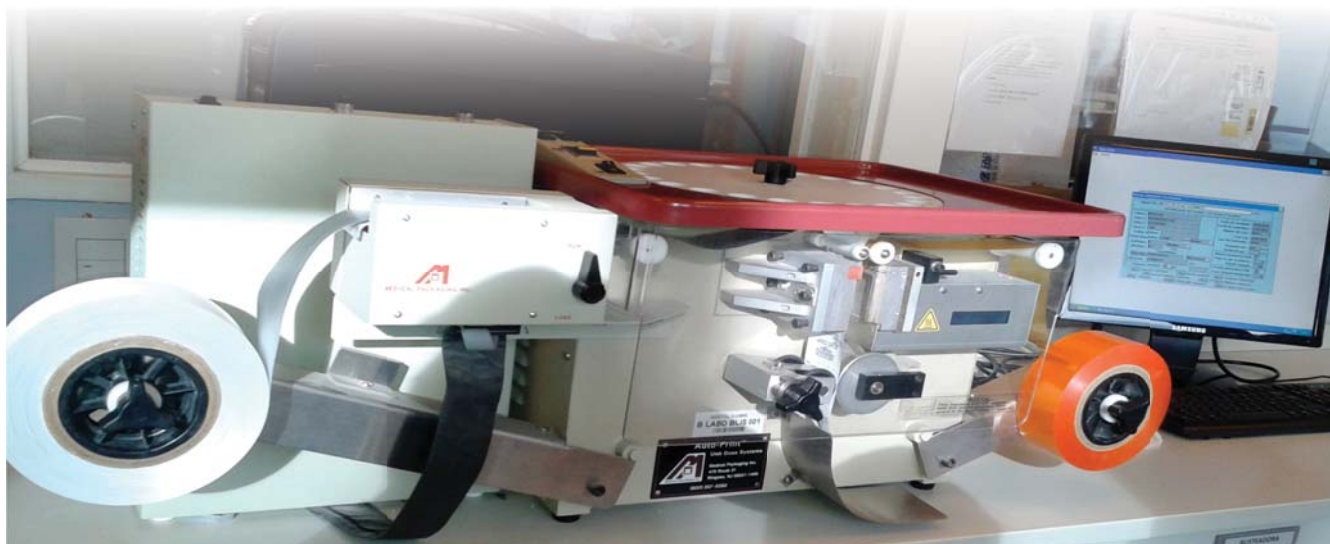
Figura 2: Máquina de re-empaqueado de dosis individuales en la Farmacia del HA
