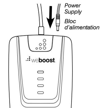
Connectez le bloc d'alimentation C.A. à l'amplificateur Connect 4G puis à la multiprise de protection contre les surtensions C.A. d'au moins 1000 joules. Si votre amplificateur Connect 4G fonctionne correctement, les voyants sont verts.
