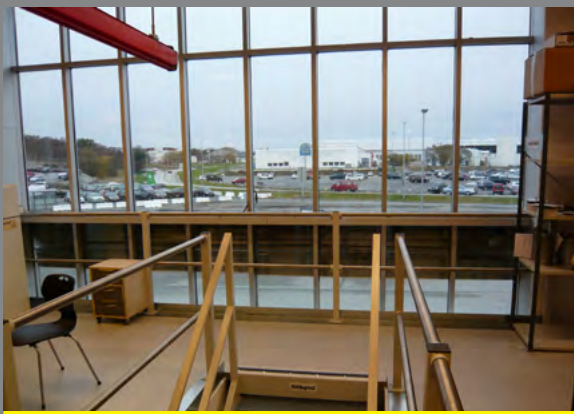
Høyde underkant drager plassert slik at gulvet flukter med drager på midten av vindu. Gir maksimal tilgang på lys! Planlegging ned til minste detalj
