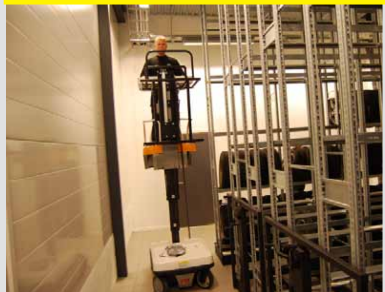
Dekkløfter med elektisk hev/senkbart lastebrett for stående hjul. Ergonomi som viktig faktor
