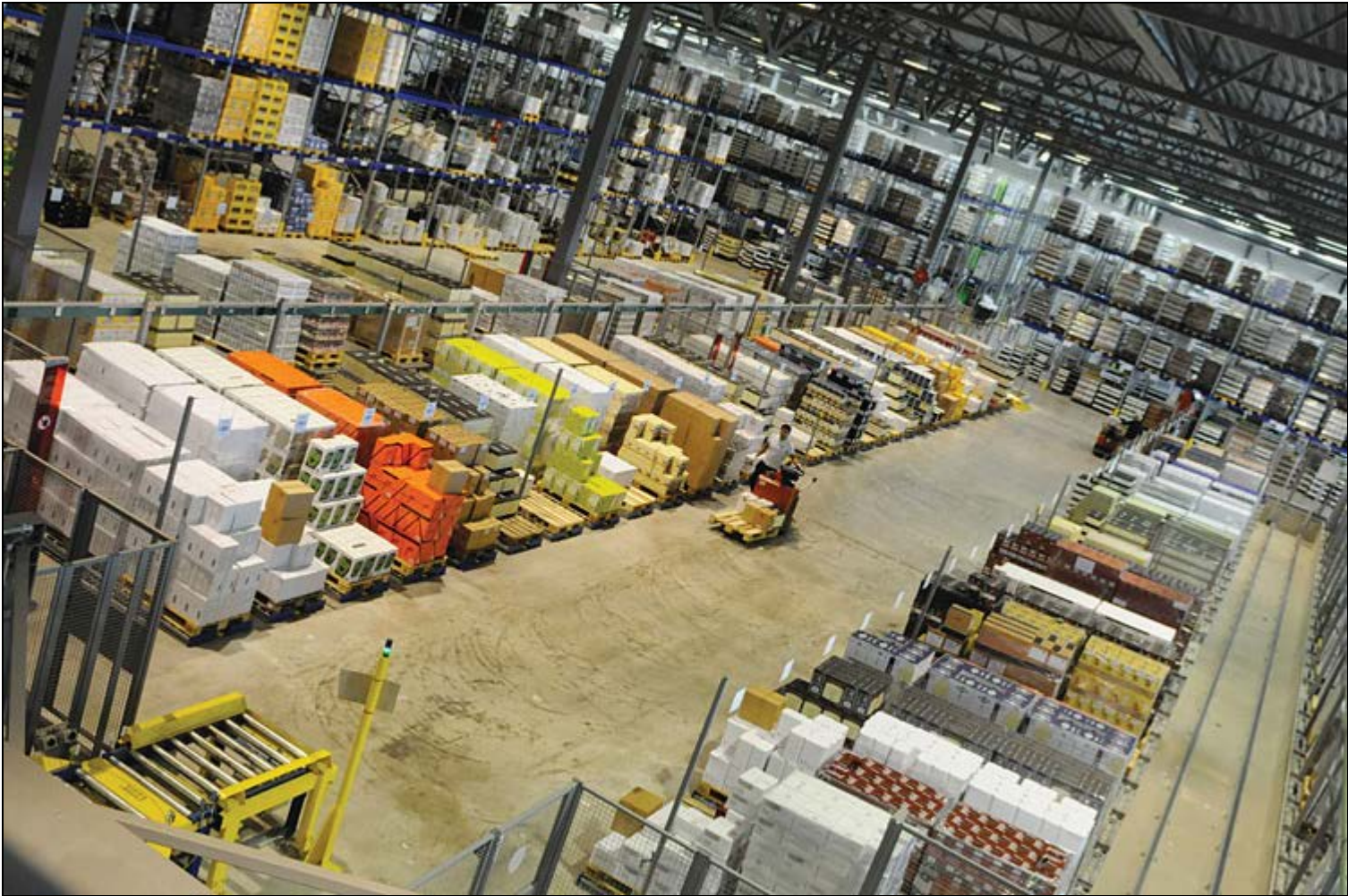
De 120 største produktene på kasseplukk har helt automatisk påfylling av monorailsystemet. Pallene til de ca 850 øvrige plassene kommer automatisk frem til uttakspunkter, hvorfra pallene deretter må håndteres med reachtruck til plukkplassene. Foto: Henning Ivarson
