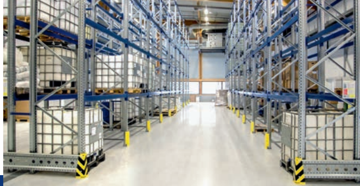
Råstofflageret og avdelingen for produksjonsplanlegging er utstyrt med pallreoler for lagring av europaller og IBC-containerne.
