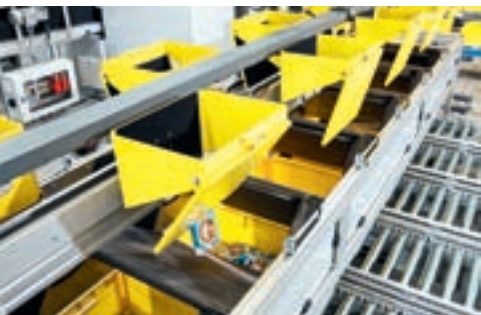
Gondolene transporterer produktene til sorteringsmålene, og der står det en ordrebeholder under.
