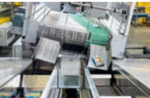
Produktene blir lagt enkeltvis i gondolene, synkronisert med sortereren.
