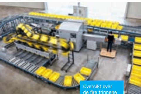
Gondolene transporterer produktene til sorteringsmålene, og der står det en ordrebeholder under.
