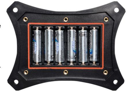
C. Instale las pilas AA (6) en la dirección que se indica dentro de cada ranura de batería y reemplazar el panel de pilas asegurándose de que la etiqueta de la CE es visible. Apriete los tornillos de la tapa de la batería al par de apriete de 116 - 121 oz/pulgadas para preservar los índices IP
