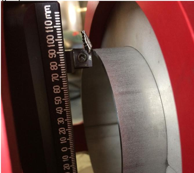
Besonders betroffen sind Rohre mit kleinen Durchmesser  $< 25,4$  mm, da sie oft mit einem Rohrschneider oder durch Schleifscheiben geschnitten werden. In diesem Fall muss das Rohr vor dem Schweißen angeplant werden, um anschließend hochwertige Schweißnähte erhalten zu können.
