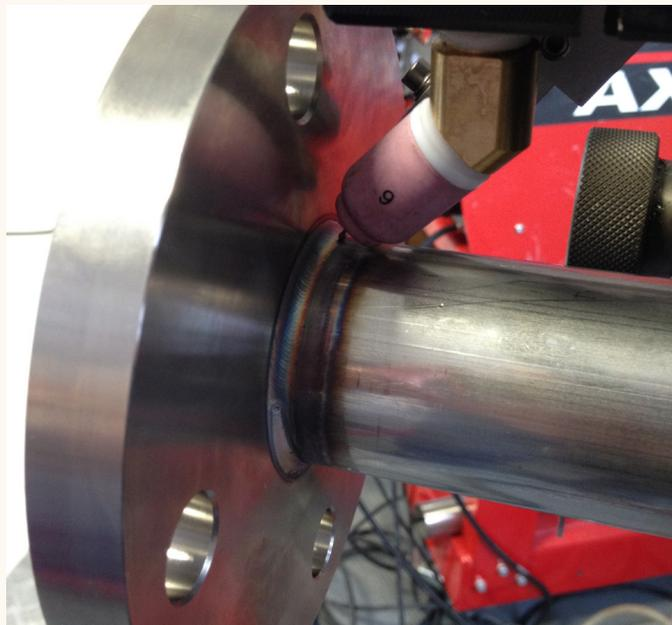
Diese Maschinen, die die Standardmaschinengestelle verwenden, die auch für das Trennen und Anfasen eingesetzt werden, bieten den Vorteil, dass sie robust und einfach zu verwenden sind. Daher ist die Produktlinie SX vor allem für einen Einsatz in einer Werkstatt oder auf einer Baustelle für die Vorfertigung bestimmt.
