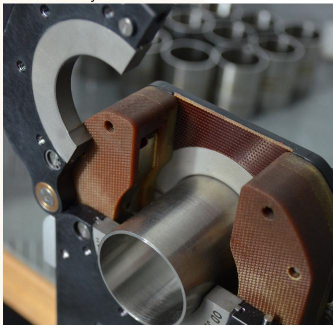
Les têtes fermées offrent une protection de gaz optimale (chambre fermée) ce qui se traduit par des soudures avec des colorations très limitées. Elles sont préconisées pour souder des tubes inox d'épaisseur < 3 mm en fusion simple sans apport de fil.
