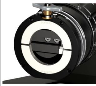
Einstellung der Werkzeuge innerhalb weniger Sekunden je nach Durchmesser des zu bearbeitenden Rohrs.
