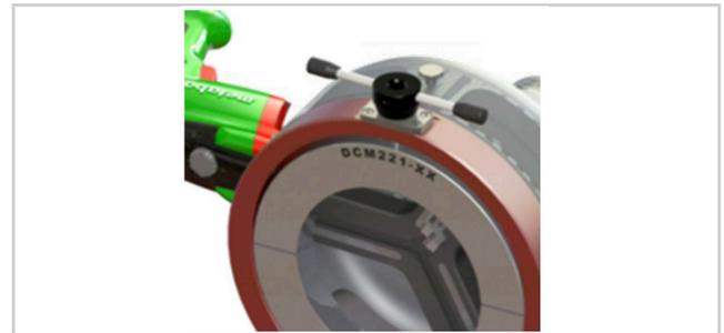
Fácil sujeción del tubo con abrazadera.
