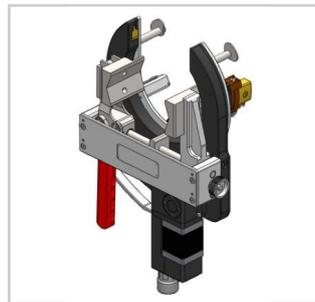
SATO-xxxE32: Motor de transmisión inclinado.
