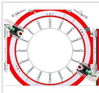
Serraggio concentrico **16 morse acciaio inox** di serie, non deforma i tubi sottili
