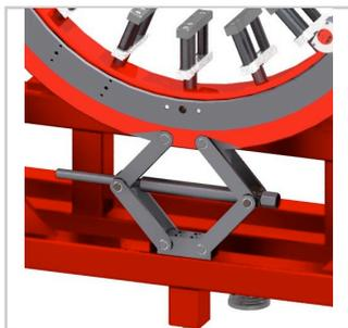
Sistema per regolazione in altezza della macchina
