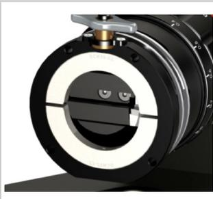
Morse di serraggio con grande apertura, per facilitare il posizionamento del tubo.
