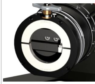
Morse di serraggio con grande apertura, per facilitare il posizionamento del tubo.
