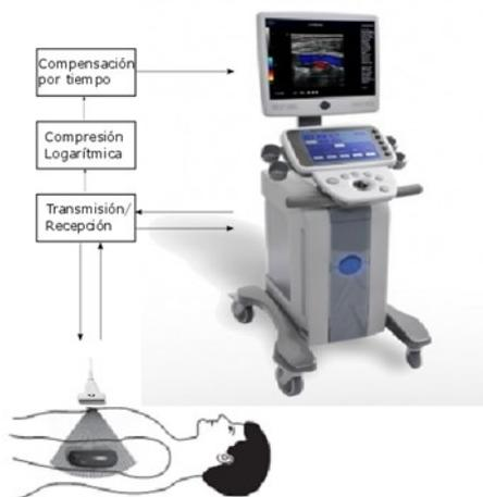
**Figura 1.** Formación de imágenes de ultrasonido. El transductor alterna entre transmisión de un pulso y recepción de señales que representan la interacción del haz acústico y las estructuras de los tejidos. En una pantalla se muestra la imagen digitalizada luego de post-procesamiento (compensación por tiempo y compresión logarítmica)
