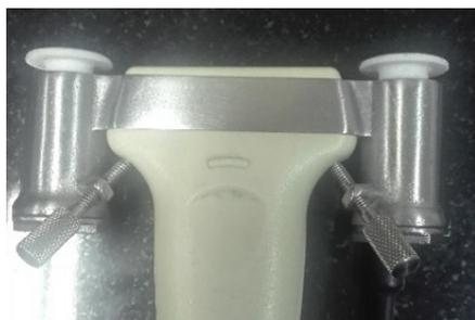
**Figura 3.** Acople mecánico de los *voice coil* en el transductor del ecógrafo
