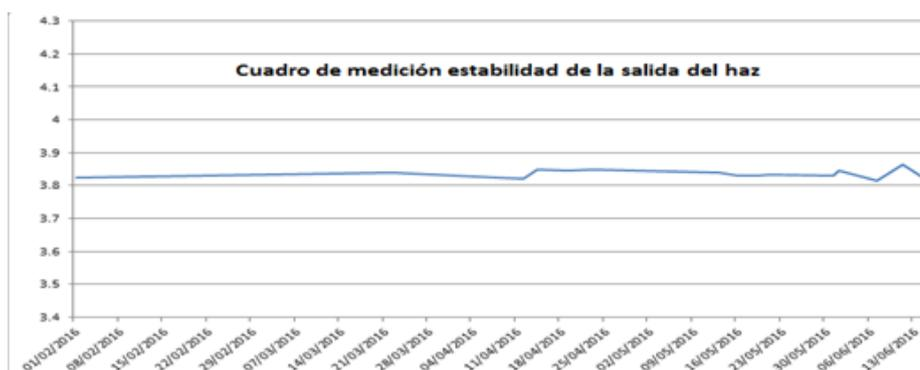
Figura 1. Gráfica de medición de estabilidad en el tiempo del equipo RIO
