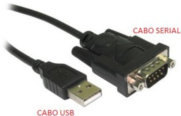
Após identificar qual a interface de comunicação, abra o Bematool (clcando com o botão direito do mouse e selecionando a opção "abrir como administrador") e selecione a opção INSTALAR DRIVER USB caso seja interface USB. Se for SERIAL, pode ir para a próxima instrução.
