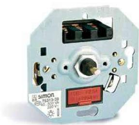
Los reguladores electrónicos de tensión de mando rotativo permiten la regulación de la tensión del circuito desde un punto de la instalación y la conexión ó desconexión desde varios puntos mediante el uso de conmutadores y cruces. La regulación de tensión del circuito se realiza de manera giratoria y la conexión y desconexión por pulsación. Ideal para la creación de ambientes y escenas lumínicas. Permite un importante ahorro enegético. Todos los artículos cumplen la normativa UNE-EN 60669-2-1.
