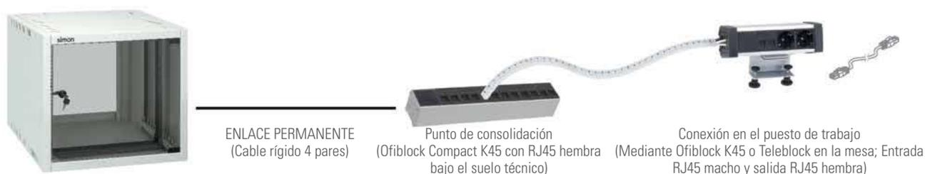
El punto de consolidación permite dejar cableada la parte fija de la instalación (ENLACE PERMANENTE) y mover con total flexibilidad la instalación del mobiliario respetando la normativa de Cableado Estructurado ISO/CEI 11.801
