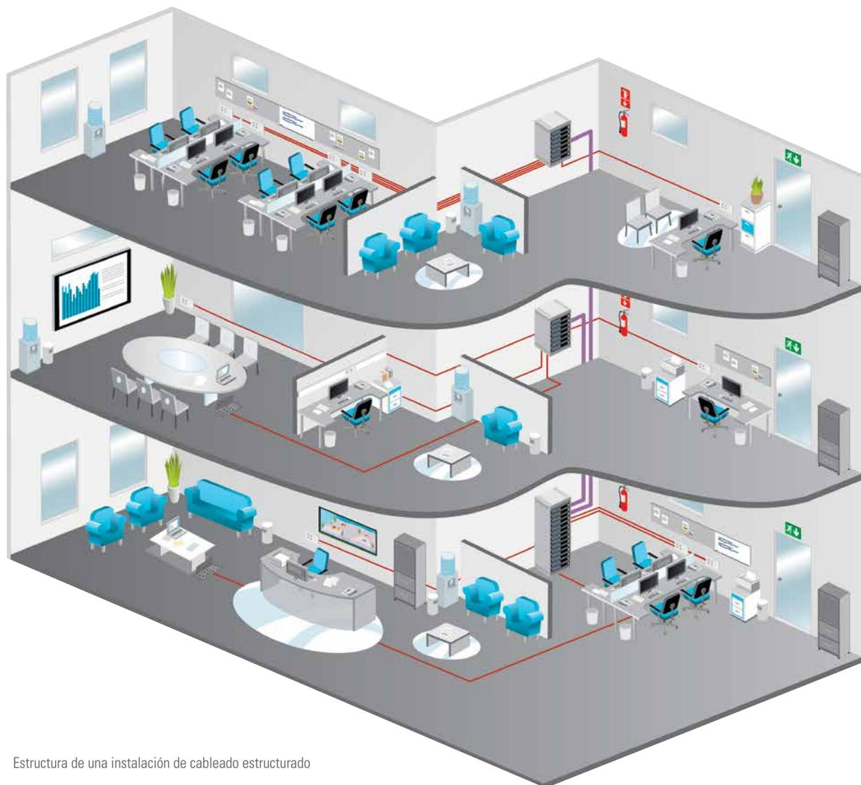
Estructura de una instalación de cableado estructurado
