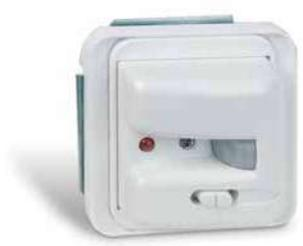
Estos detectores facilitan la conexión de cargas a través de la captación de calor móvil, rearmables por un movimiento de la fuente de calor, pero a diferencia de los demás detectores estos también rearmen la temporización mediante cualquier sonido que se produzca en su entorno.
