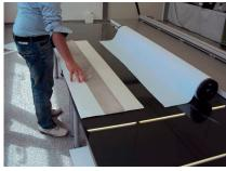
**Step 3:** Heben Sie die SK-Folie an einer Seite an, so dass das Abdeckpapier flach auf dem Tisch liegen bleibt und die selbstklebende Seite der SK-Folie nach oben zeigt.
