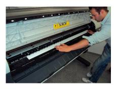
**Step 9:** Ziehen Sie das Material durch den Drucker.
