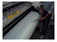
**Step 10:** Entfernen Sie die SK-Folie und falten Sie sie zurück auf das Abdeckpapier. Sie können die Folie später wieder verwenden.
