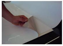
Step 5: Falten Sie die SK-Folie zurück, so dass das VARItex zwischen Folie und Abdeckpapier eingesiegelt ist.
