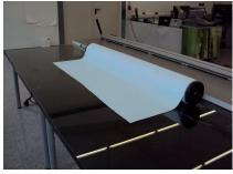
Step 2: Schneiden Sie einen 30-40 cm langen Streifen selbstklebende Folie (SK-Folie) ab. Die SK-Folie sollte in etwa dieselbe Breite haben wie das VARItex, auf 2-3cm mehr oder weniger kommt es aber nicht an.
